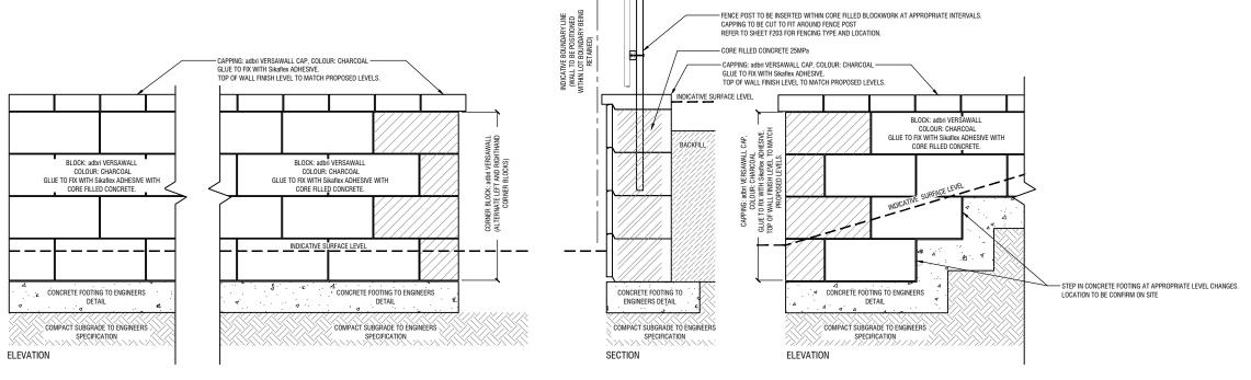
WALL TYPE 2 - RETAINING WALL (TYPICAL)
