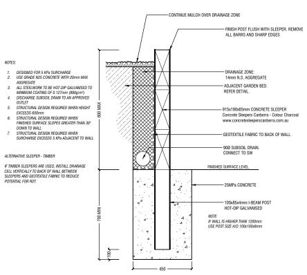
WALL TYPE 3 - I BEAM / CONCRETE SLEEPER RETAINING WALL
